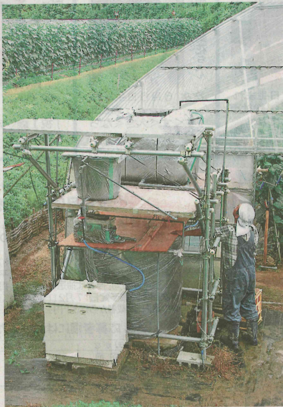
普及が進む太陽光発電利用の自動かん水装置＝岡山県久米南町
